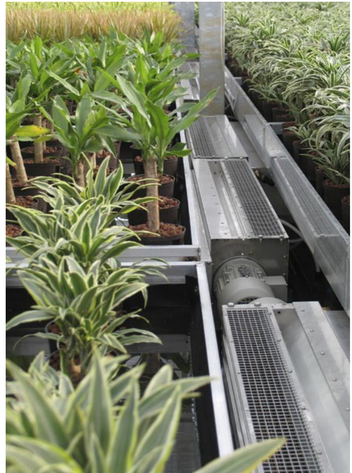
Rechthoekige Finwibex warmtewisselaar in gebruik in de pilotkas april 2006
